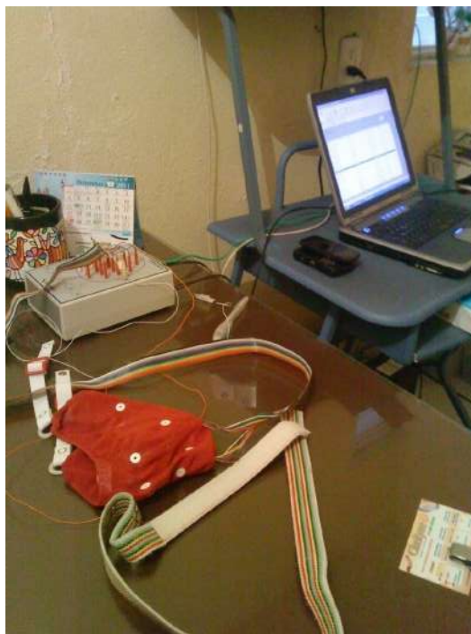
Figura 4. Amplificador Vector PSG de 32 canales, marca BIOSCIENCE, fibra óptica con paquete de cómputo STELLATESYSTEM canadiense versión 5.1. Fuente: Ventura 2013, Vallejo-Trujillo, Pérez, (2017).
